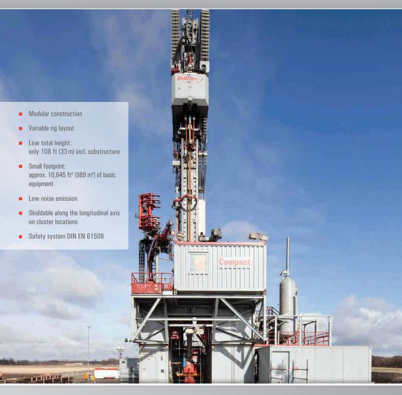
DRILLING RIG VDD 200.1 COMPACT
